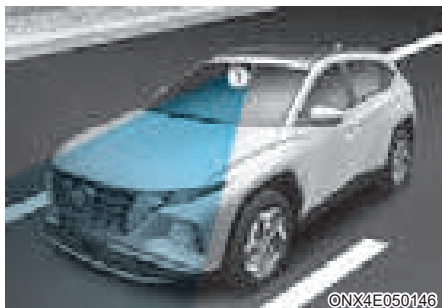
[1]: камера переднего обзора
