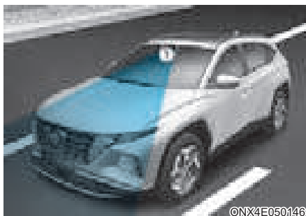
[1]: камера переднего обзора
