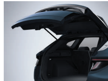
Автоматты ашу жүйесі бар жүксалғыш есігінің электр жетегі
